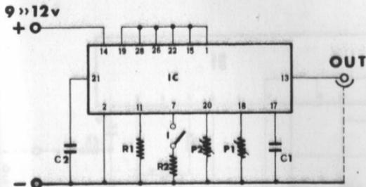
Grazie ad un particolare circuito integrato si possono ottenere svariati tipi di suoni con un numero ridottissimo di componenti. I vari effetti si ottengono con le regolazioni di due potenziometri e di un interruttore.
